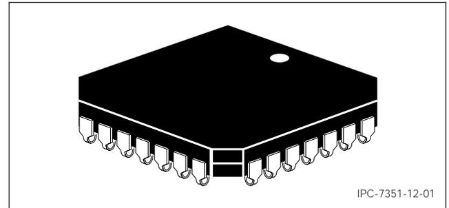
**Figure 12-1 PLCC Construction**
